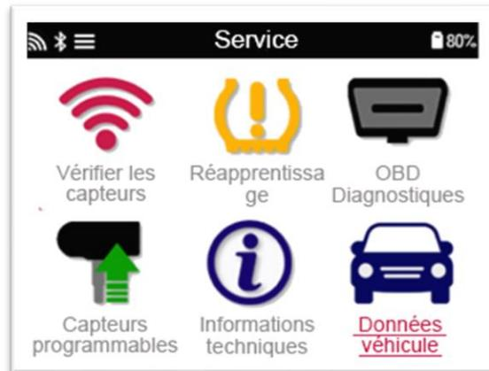
Le menu donne un accès direct à des écrans spécifiques qui affichent les données relatives aux véhicules. Cette option est utile si l'utilisateur veut jeter un second coup d'œil aux données des capteurs, aux données OBD ou s'il veut imprimer les données du dernier véhicule analysé via l'imprimante Bluetooth.
