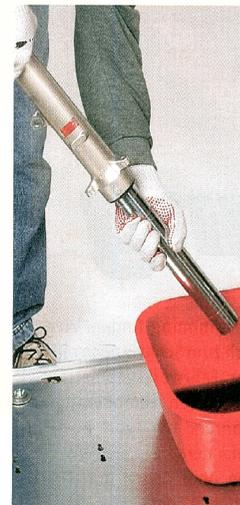
**6** Gabelöl einfüllen – Viskosität beachten! Ist ein Luftpolster vom Gabelfederhersteller vorgeschrieben, dieses ohne Feder, im niedergedrückten Zustand (siehe Foto) messen. Das Standrohr zirka 15- bis 20-mal im Tauchrohr auf- und abbewegen, damit die Luft komplett entweichen kann. Nun die Messung erneut vornehmen. Wird vom Federhersteller eine bestimmte Ölmenge pro Holm vorgeschrieben, diese mit einem skalierten Messbecher abmessen.
