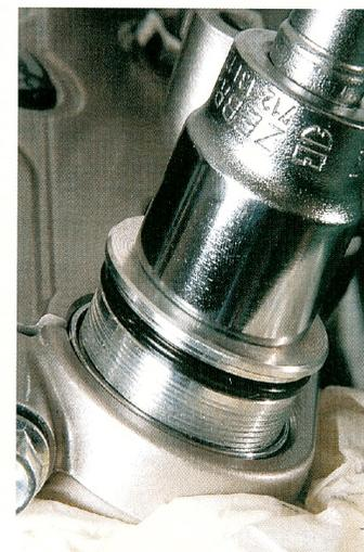
**9** Den Verschluss-Stopfen wieder einschrauben. Achtung: Dieser ist in den meisten Fällen aus Aluminium gefertigt und besitzt ein Feingewinde, das beim Einschrauben sehr leicht beschädigt werden kann. Nun den zweiten Holm wie beschrieben umrüsten.
