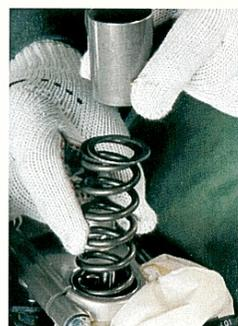
**3** Den Verschluss-Stopfen des ersten Gabelholms entfernen. Vorsicht, dieser steht möglicherweise unter Spannung. Die Lage der Distanzhülsen und Scheiben für den späteren Zusammenbau notieren. Den O-Ring des Verschluss-Stopfens kontrollieren: Ist er spröde oder beschädigt – tauschen.
