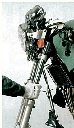
**4** Die Klemmungen der unteren Gabelbrücke des Standrohrs lösen und den Gabelholm durch leichtes Drehen nach unten aus den Brücken ziehen.
