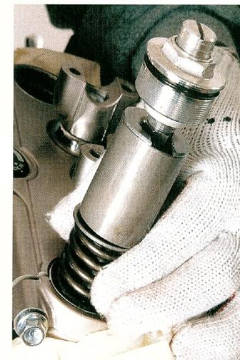
**8** Die progressive Austauschfeder mit der eng gewickelten Seite nach oben in den Gabelholm stecken. Etwaige Distanzstücke und Scheiben wie vom Gabelfederhersteller vorgeschrieben, hinzufügen.
