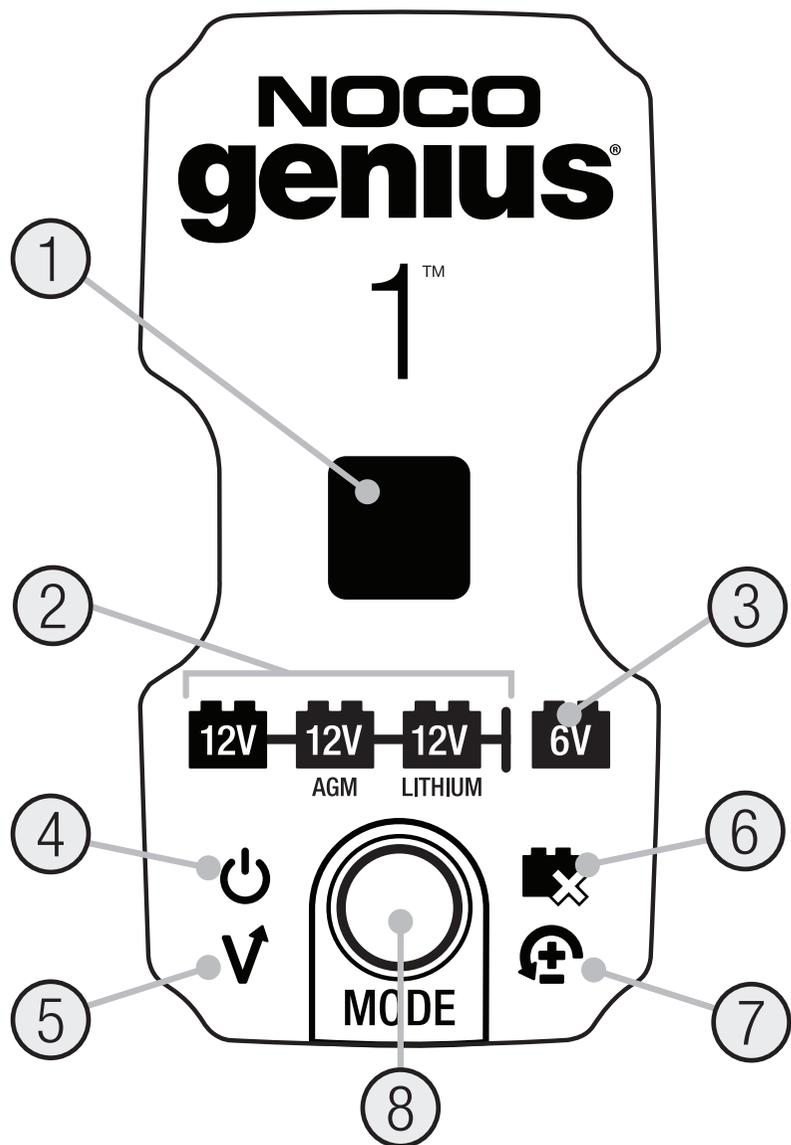
**1.) LED de carga** Indica el estado de carga de la batería conectada.
