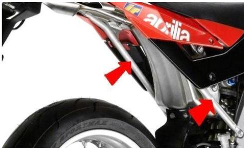
Der Förderschlauch kann entlang der Schwinge verlegt werden unter Benutzung der Omegahalter und Klebers. Die Spendereinheit mit der kleinen Spenderplatte und der Schlauchschelle (Teile 20 & 21) an der Schraube des Kettenschutzes befestigen. Weitere Informationen, siehe - [Anleitung Spenderplatte](#). Die Düse soll zwischen 6 und 7 Uhr auf das Kettenrad zeigen, die abgeschnittene Seite nach außen.
