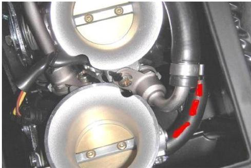
Das RMV kann am Rahmen montiert werden. Je vertikaler das RMV montiert wird desto besser. Vermeiden Sie die Nähe des Auspuffs und des Motors. Für weitere Informationen, sehen Sie in die "Easy step Installationen" - [RMV Positionen generell](#).
