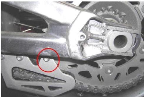
Nach der Montage das System befüllen und vorpumpen, dafür das Einstellrad auf "prime" stellen. Den Motor starten und die Tropfenmenge am Einstellrad reduzieren, bis Sie 1 bis 2 Tropfen pro Minute erhalten. Überprüfen Sie Ihre Kette nach der ersten Fahrt und regeln Sie falls nötig nach. Um beste Ergebnisse zu erzielen reinigen Sie Ihre Kette vor dem Anbau des Scottoilers mit Paraffin oder ähnlichem.
