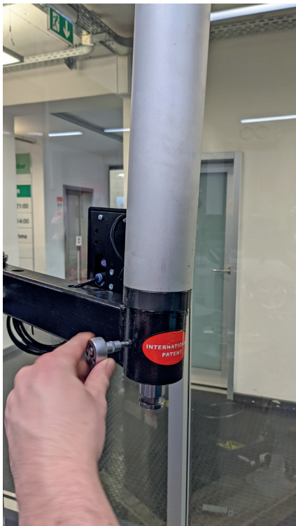
Pneumatik-Zylinder mit den beiden Innensechskantschrauben und den Andrückrollenhalter mit der Innensechskantschraube an den Hilfsarm montieren
