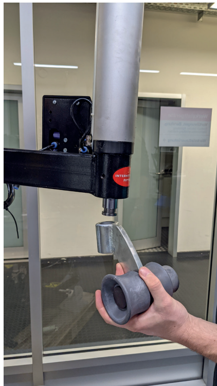
Pneumatik-Zylinder mit den beiden Innensechskantschrauben und den Andrückrollenhalter mit der Innensechskantschraube an den Hilfsarm montieren
