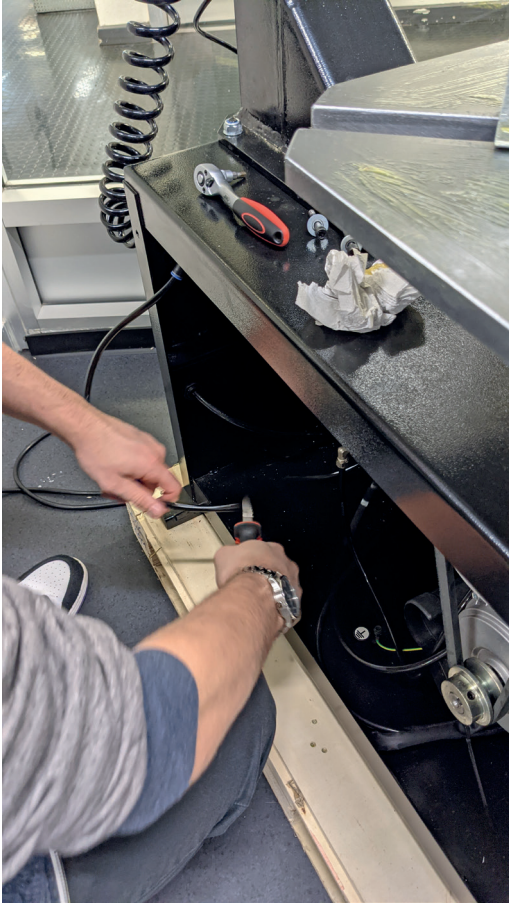
Den Schlauch des Hilfsarmes mittels mitgeliefertem T-Stück mit der Luftleitung verbinden
