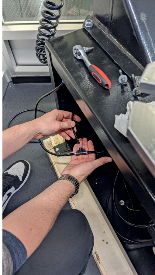
Den Schlauch des Hilfsarmes mittels mitgeliefertem T-Stück mit der Luftleitung verbinden
