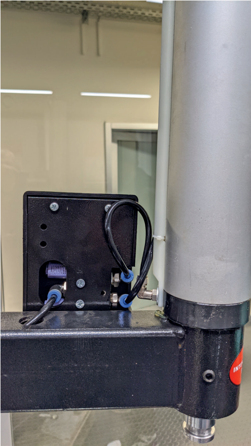
Beide Luftleitungen des Zylinders mit den Anschlüssen vom Betätigungsschalter verbinden
