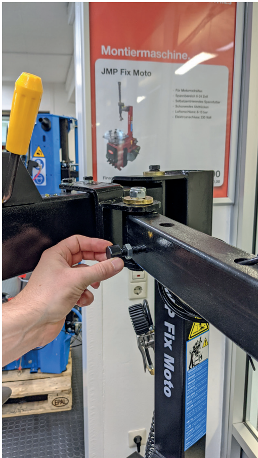
Anschlagschraube in den Schwenkarm einsetzen
