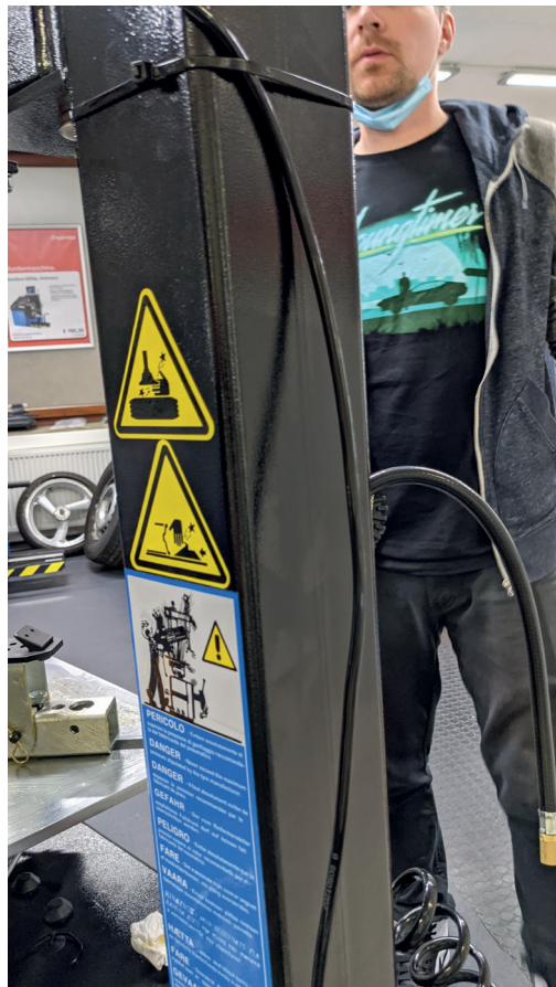
Den Luftschlauch des Hilfsarmes hinter der Montagesäule verlegen und mittels Kabelbindern fixieren. Danach den Schlauch hinten in die Maschine einführen
