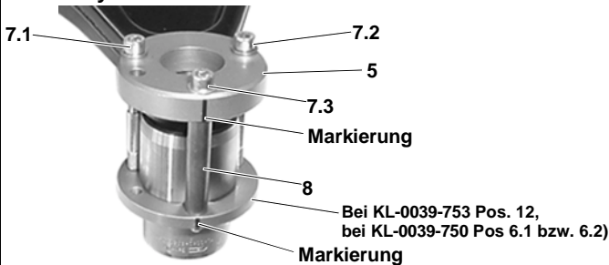
Abb. 8: Pressrahmen an Querlenker ansetzen, Traggelenk ausbauen.
