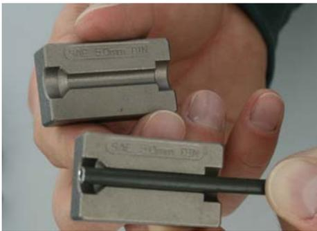
entnehmen sie die dem Durchmesser der Bremsleitung entsprechenden Klemmbacken (5, 6, oder 7), legen die Bremsleitung dazwischen.
