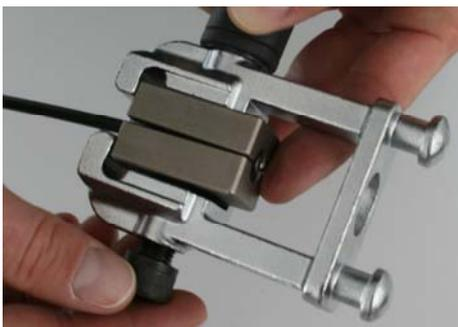
Betätigen Sie die Spansschraube um die Bremsleitung in den Klemmbacken fest einzuspannen.
