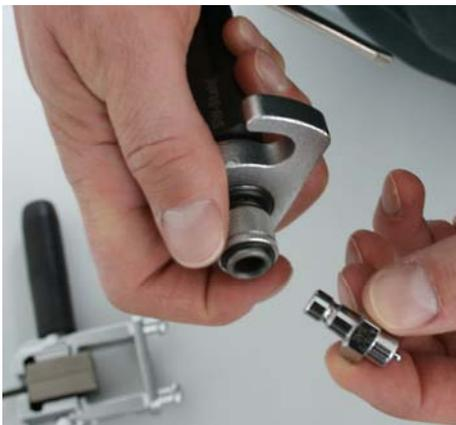
Nehmen Sie die Druckspindel (3) und stecken das für die entsprechende Bördelung notwendige Druckstück (9 - 13) ein.
