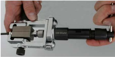
Verwenden Sie den Drehgriff (4) um die Druckspindel (3) zu betätigen und drehen diesen rechtsherum bis Sie einen Gegendruck spüren, um die Bördelung fertigzustellen.
