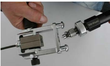
Nun schrauben Sie die Druckspindel (4) zusammen mit dem Druckstück in den Gegendruckkörper (2)
