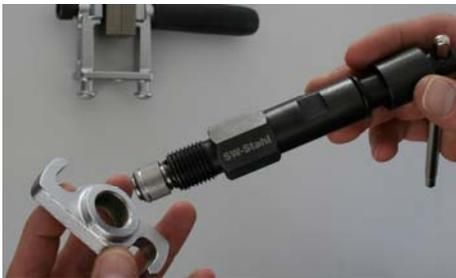
Drehen Sie nun die Gegendruckplatte (2) locker auf die Spindel. ACHTUNG: Noch nicht ganz fest drauf drehen!!!!
