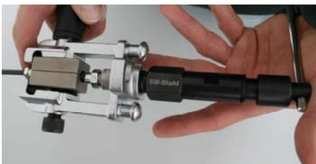
Nun mit dem Drehgriff (5) linksherum drehen, um das Druckstück zu lösen, dann die komplette Druckspindel (4) aus dem Gegendruckkörper (2) herausdrehen.
