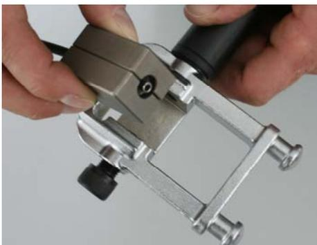
Verwenden Sie die Klemmbacken so, dass die gewünschte Bördelkante (90° bzw. 45°) entsteht
