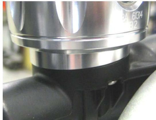
Kontrollieren Sie den Flüssigkeitsstand im Schauglas des Behälters vor jeder Fahrt. Bringen Sie dazu den Bremsflüssigkeitsbehälter in senkrechte Position.
