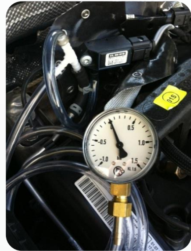
Anschluss des Manometers am Differenzdrucksensor mit genügend langem Schlauch, so dass das Manometer während der Fahrt beobachtet werden kann.
